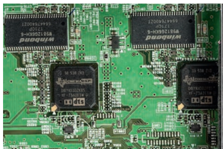
Podczas gdy konkurenci wybierają procesory Analog Devices, Yamaha jest od lat wierna układom rodziny Cinema DSP firmy Texas Instruments.
