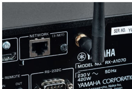
Tylko jedna antena obsługuje zarówno Wi-Fi, jak i Bluetooth. Ten ostatni jest tutaj wyjątkowy – pozwala nawet przesłać sygnał do słuchawek.
